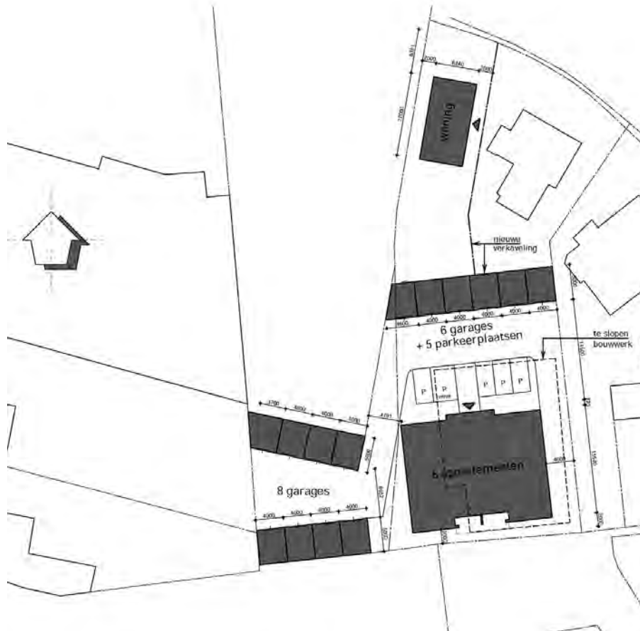
Afbeelding 2.5: Locatie te slopen bebouwing en bouwvlakken nieuwbouw ((bron: De Bruin Architecten bv BNA; datum: 08-02-2018).
